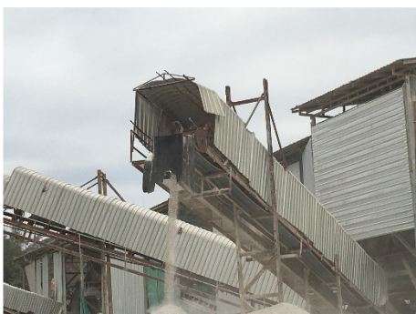
รูปที่ 2-18: การปิดคลุมสายพานลำเลียง
