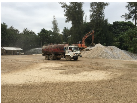
รูปที่ 2-22: การฉีดพรมน้ำบริเวณกองสต็อกแร่
